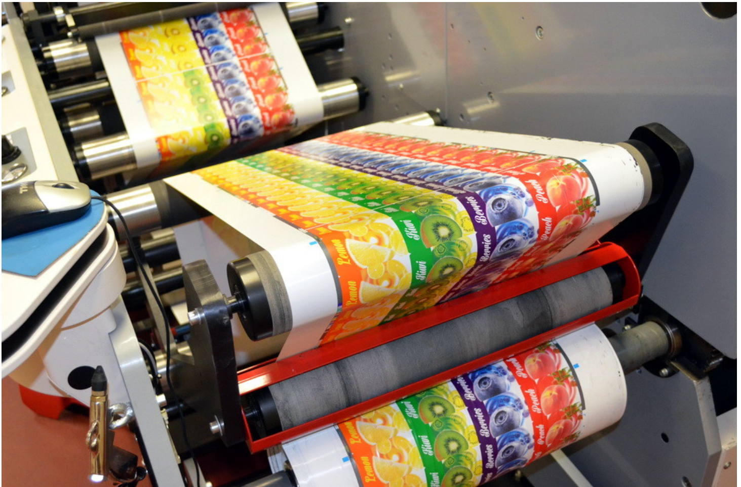
Рис. 1 Печать этикеток на флексомашине.
