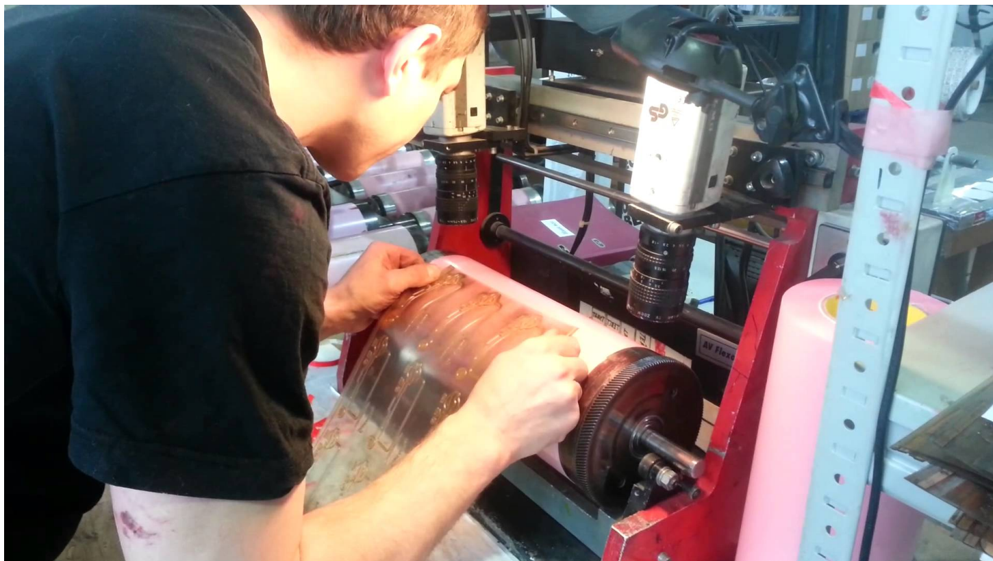
Рис. 3 Установка флексоформы на вал флексомашины.
